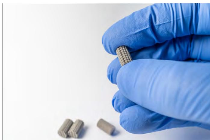
2019年获奖论文分析了钛-钽合金（Ti-25Ta）制成的结构性能（照片：N. Soro）
